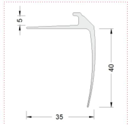
Zur Verlegung von Belägen bis 5mm, mit Einschub.
