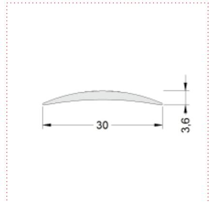
Übergangsprofil zwischen Belägen. Durch die geringe Profilhöhe speziell für Hartbeläge geeignet.
