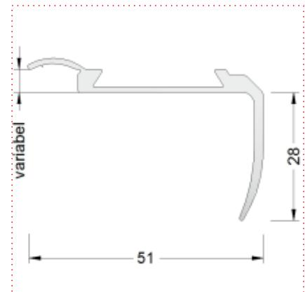
Treppenprofil für Beläge bis 5mm, mit umschlagbarem Endteil zum Einklemmen von Belägen. Geignet für Renovierungen.
