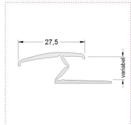
Variabel einsetzbares Übergangsprofil zwischen Belägen gleicher oder unterschiedlicher Höhe. Auch als Abschlussprofil einsetzbar.
