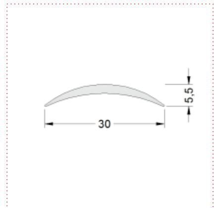
Übergangsprofil zwischen Belägen. Robuste Ausführung Aluminium 2,2mm dick, 5,5mm hoch, Messing 1,25mm dick und Edelstahl 1,00mm dick.
