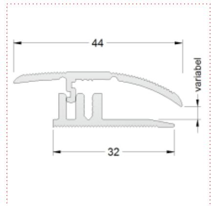
Hochwertiges und universelles Profilesystem zum Schrauben für alle Hartbeläge bis 16mm Höhe. Sehr variabel durch die individuelle Kombination der Basisprofile und der verschiedenen Deckelprofilen: Übergangsdehnfugenprofil, Abschlussprofil und Ausgleichsprofil.
