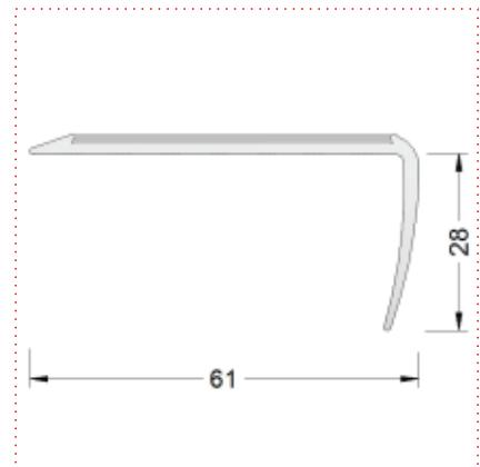
Zur universellen Verlegung auf Treppen, zur Sanierung auch im Objektbereich. Flach auslaufend.
