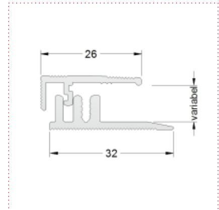
Hochwertiges und universelles Profilesystem zum Schrauben für alle Hartbeläge bis 16mm Höhe. Sehr variabel durch die individuelle Kombination der Basisprofile und der verschiedenen Deckelprofilen: Übergangsdehnfugenprofil, Abschlussprofil und Ausgleichsprofil.
