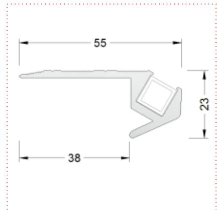
Treppenkantenprofil mit beleuchtetem Leuchtkanal zur Verlegung in Kinos, Restaurant, Discotheken etc. Für ästhetisch anspruchsvolle Objekte und zur Unterstützung der Sicherheit bei gering beleuchteten Treppenstufen.
