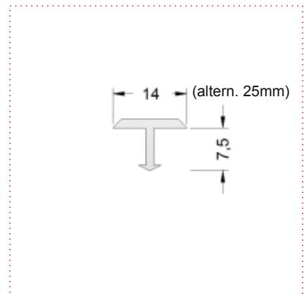
T-Profil als Übergangsprofil und Trennprofil zur nachträglichen Verlegung zwischen Beläge gleicher Höhe.
