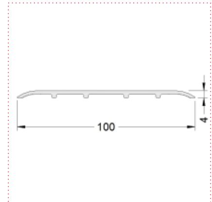
Übergangsprofil zwischen Belägen und über Dehnfugen, auch als Schutz- und Stoßleiste an der Wand.
