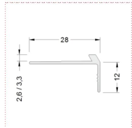
Treppenprofil für Lino, PVC und Korkbeläge. Erhältlich in 2 Ausführungen.
