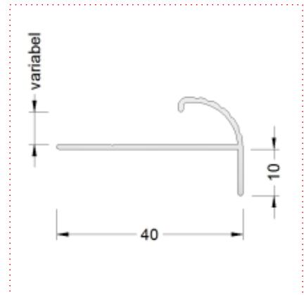
Zur Verlegung von Teppichbelägen auf Treppen und Absätzen. Durch Zusammendrücken des oberen Abschlusses wird der Belag dauerhaft eingeklemmt.
