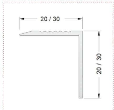
Universell einsetzbarer Messingwinkel, flach auslaufend. Gerillt, alternativ glatt. In 3 Ausführungen erhältlich.
