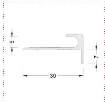
Zur Verlegung von Belägen bis 5mm, mit Einschub und Riffelung.
