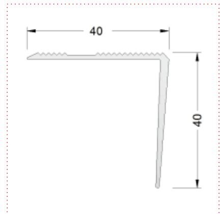
Treppenkantenprofil zur universellen Verlegung auf allen Belägen, besonders für die Treppensanierung geeignet, mit Antirutschrillen. Flach auslaufend.
