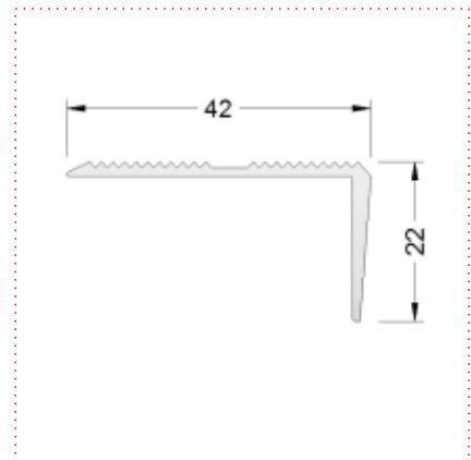
Treppenkantenprofil zur universellen Verlegung auf allen Belägen, mit Antirutschrillen.
