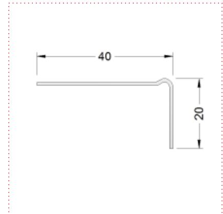
Typ S für Beton. 40mm Auflage, 20mm Fuß.
