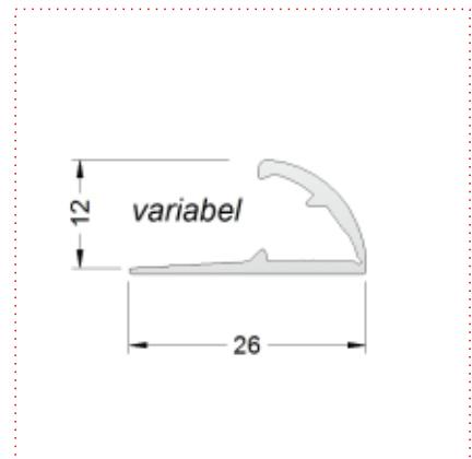
Universell einsetzbarer Abschluss zu Teppichen und anderen Belägen. Durch Zusammendrücken des Abschlusses wird der Belag dauerhaft eingeklemmt.
