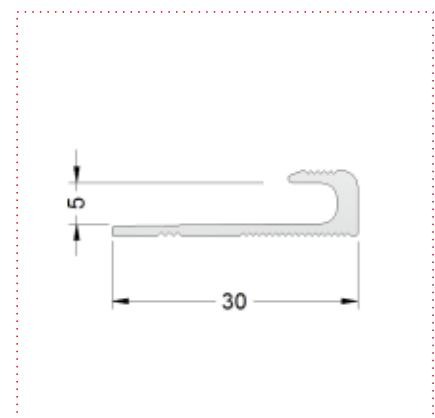
Abschlussprofil zu Belägen bis 5mm, mit Einschub, auch als Sockelabschluss einsetzbar.
