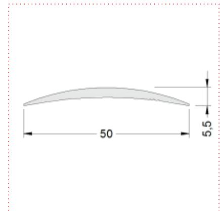
Übergangsprofil zwischen Belägen, auch als Schutz- und Stoßleiste an Wänden.
