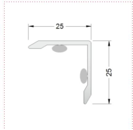
Universell einsetzbares Kantenschutzprofil mit abgerundeten Außenkanten.
